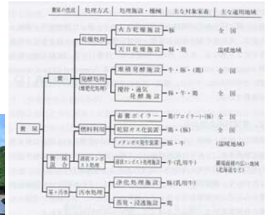
図5-26 現在採用されている主な処理方式と施設・機械 (上野克美, 1991)
